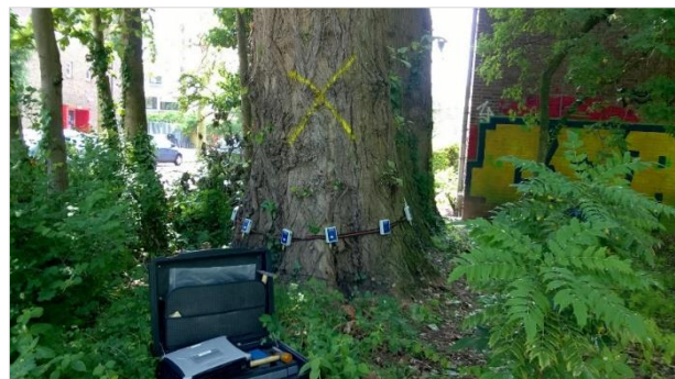
afb. 16: Onderzoek naar de breukvastheid met behulp van een geluidstomograaf
