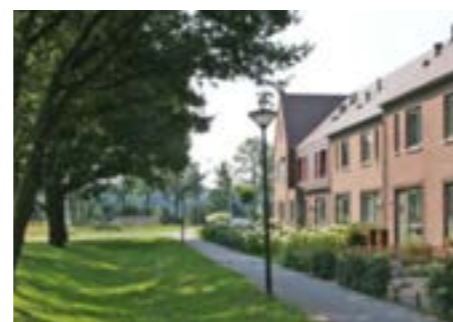
Verlaagd maaiveld t.b.v waterberging
